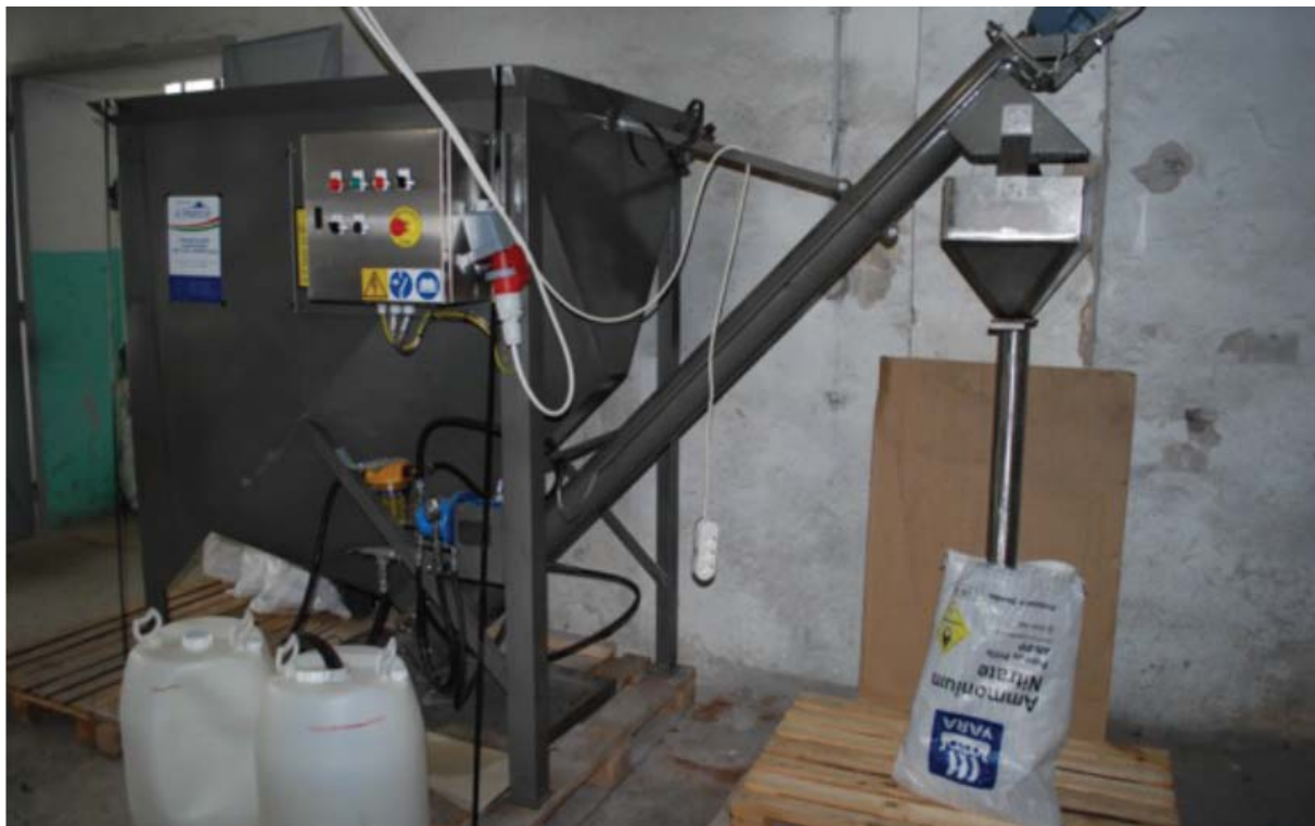
16. ábra: ANFO MIXER 1000 mobil robbanóanyag keverő berendezés (forrás: Austin Powder Hungary Kft.)
